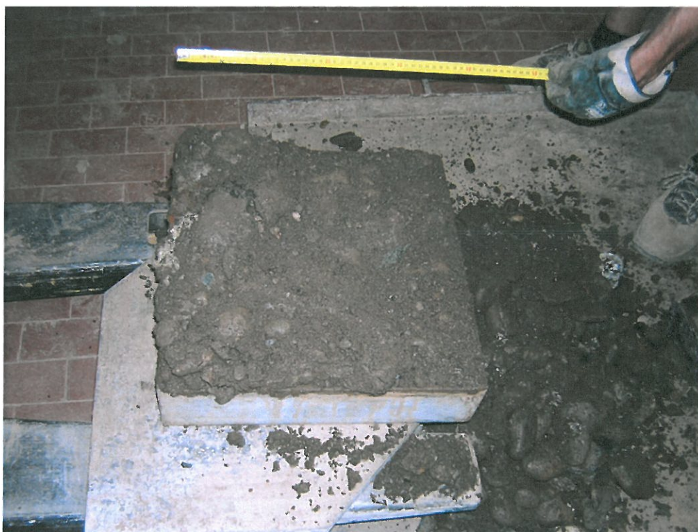
La preparazione dei campioni nella scatola di taglio da sottoporre a prova.
