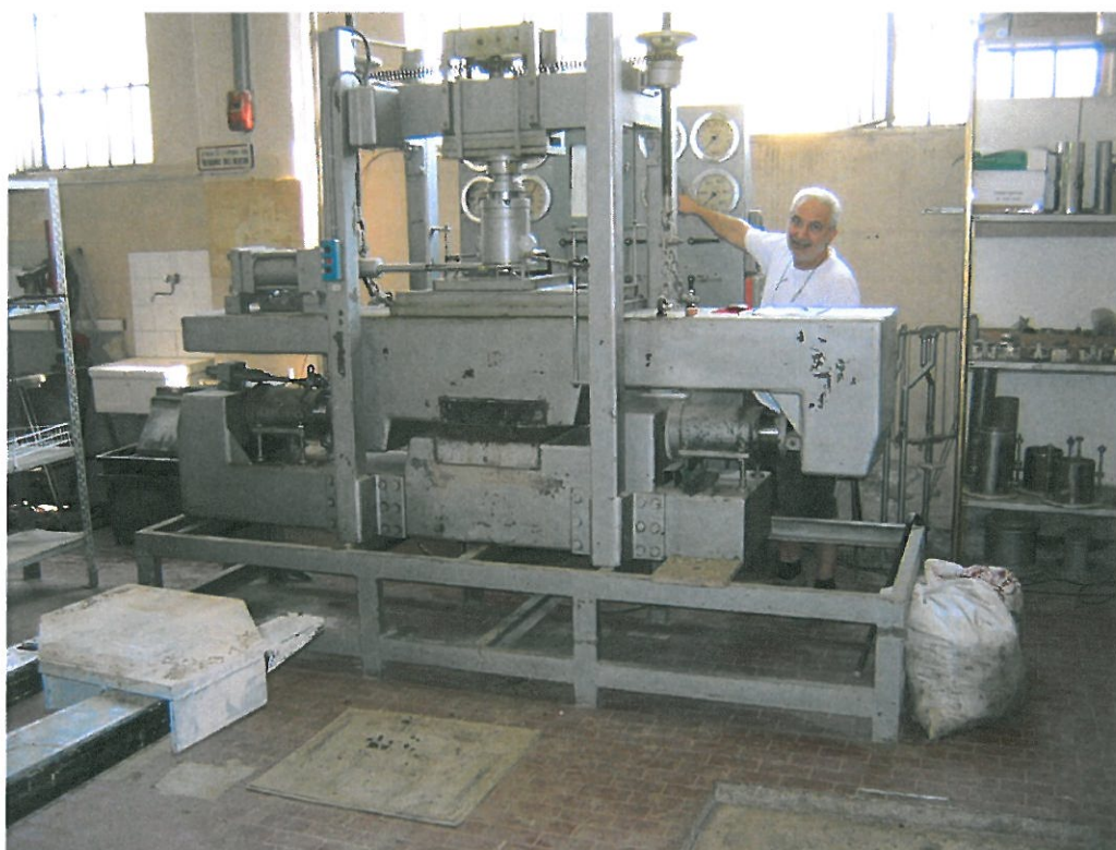
Apparecchiatura di taglio diretto grande ("Krsmanovic") in dotazione al laboratorio GeotecnaLab S.r.l.
