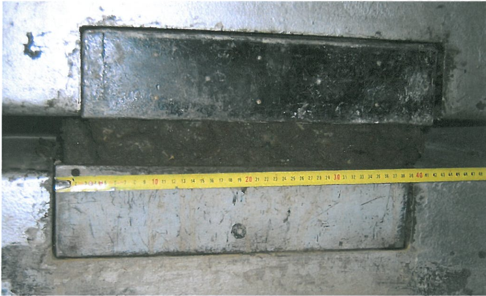
Particolare della scatola di taglio 37,5x37,5x21,0 cm. con campione dopo la prova
