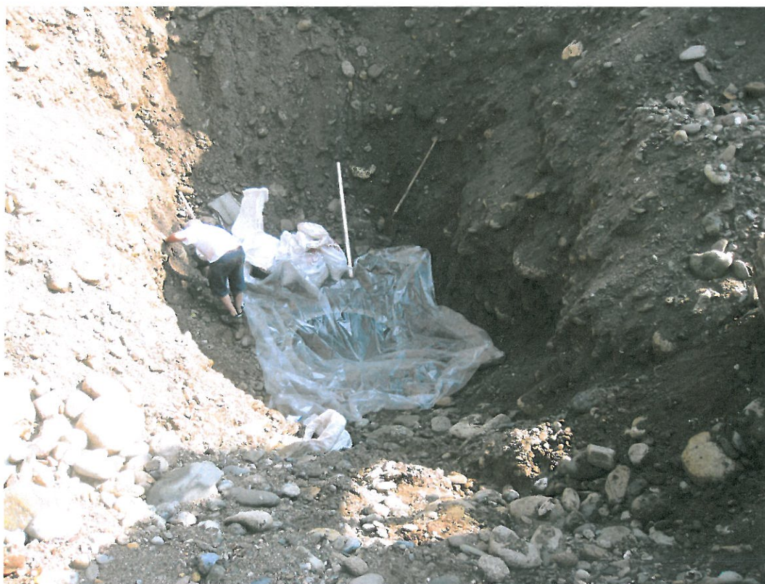
Le fasi di preparazione della prova di conducibilità idraulica.
