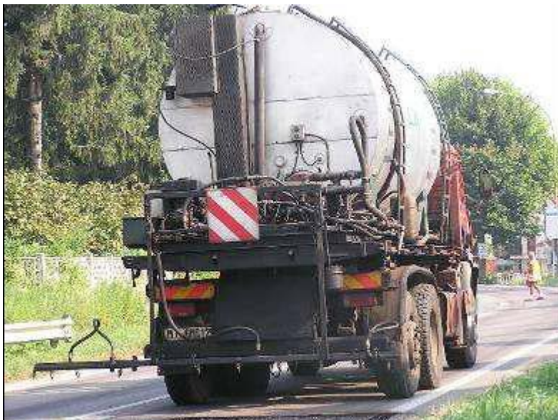
Applicazione emulsione bituminosa automatica.
